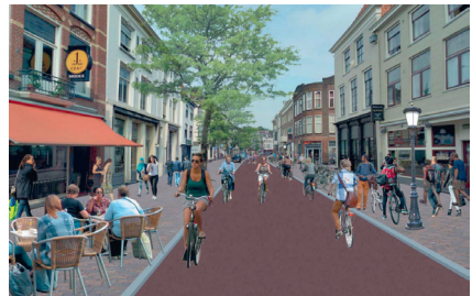
▲ Utrecht (Pays-Bas), Voorstraat : la piste en contresens (photo 2018) ne sécurise qu'un seul sens, laissant les vélos dans le sens général cohabiter avec un trafic significatif, dont de nombreux bus. La création d'une vélorue en 2019 (photo-montage), grâce à un trafic motorisé diminué (changement d'itinéraires des bus et nouveau plan de circulation), permet d'améliorer la sécurité et le confort des vélos dans le sens général et d'élargir les trottoirs. (Google Street View et utrecht.nl)
