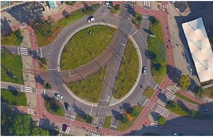
▲ Delft (Pays-Bas), Delflandplein : un giratoire traversé par des voies bus et tram, ceinturé par une piste bidirectionnelle prioritaire sur plateau traversant, et non circulaire. (Google Maps)
