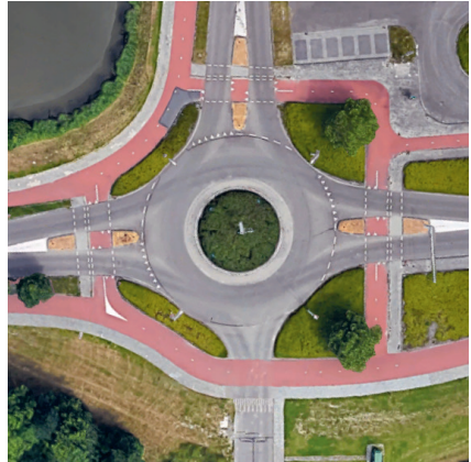
▲ Leeuwarden (Pays-Bas), Kalverdijkje : la piste bidirectionnelle n'a pas la priorité sur trois des quatre branches. La quatrième branche est une impasse traitée avec une piste continue et un trottoir traversant. (Google Maps)
