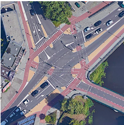
▲ Bois-le-Duc ('s Hertogenbosch, Pays-Bas), Brugplein : un exemple de carrefour complexe qui combine protection et efficacité des chemements cyclables, notamment pour tourner à gauche. (Google Maps)
