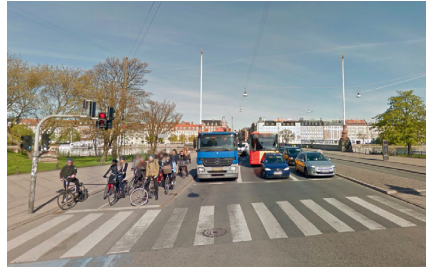
▲ Copenhague (Danemark), Dronning Louises Bro : la ligne d'arrêt motorisée est reculée par rapport à celle des vélos. Le respect de cette ligne est favorisé par un marquage plus explicite qu'en France et par l'absence de feu répétiteur, qui est quasi systématiquement ajouté en France, et qui pousse les automobilistes à coller au feu. (Google Street View)
