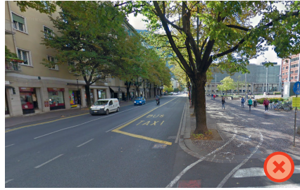
▲ Bolzano (Italie), via Roma : en-dehors de l'hyper-centre dont l'accès motorisé est limité, les vélos disposent de peu d'aménagements cyclables de qualité. Ici une piste peinte sur le trottoir d'un côté et une bande cyclable très étroite de l'autre. (Google Street View)
