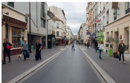
▲ Paris, 14 e , rue Daguerre 2014 / 2017 : les trottoirs et la chaussée ont été mis quasiment au même niveau, et le stationnement a été supprimé. (Ville de Paris)
