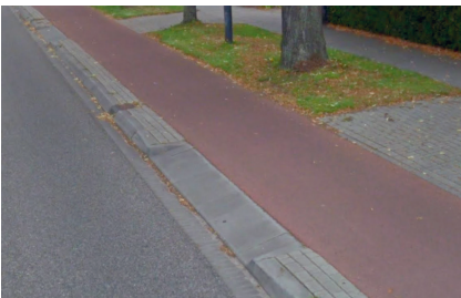
◀ Vught (Pays-Bas), Bosscheweg : la piste surélevée garde sa continuité et ne s'abaisse pas au droit des entrées motorisées de chaque pavillon. (Google Street View)
