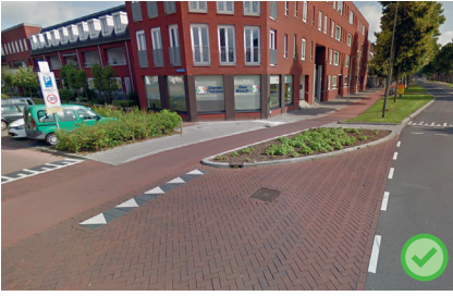
▲ Bois-le-Duc ('s Hertogenbosch, Pays-Bas), Muntelbolwerk: quand l'espace le permet, décaler la piste favorise des croisements orthogonaux avec les voitures tout en libérant un espace de stockage pour les vélos qui veulent tourner à gauche. (Google Street View)
