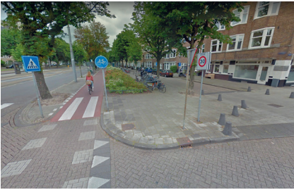
▲ Amsterdam (Pays-Bas), Rooseveltlaan : la contre-allée est doublée d'une piste cyclable. (Google Street View)
