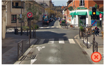
▲ Vincennes, rue des Vignerons : un trafic strictement local, un plateau traversant... mais des feux, des passages piétons, et des barrières, en contradiction totale avec la volonté d'apaisement. (Google Street View)
