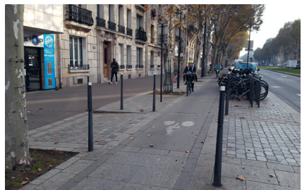
▲ Paris 14 e , boulevard Jourdan : les potelets protègent la piste au droit d'une entrée charretière avec un espace (1,95 m) plus large que la piste. Ils sont en métal donc résistants dans le temps mais dangereux en cas de collision. (Paris en Selle)
