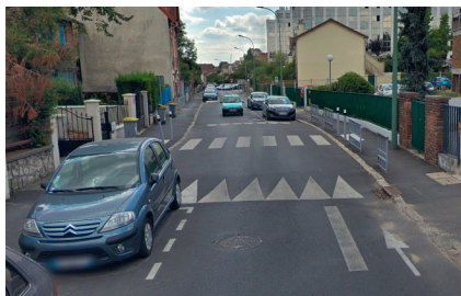
▲ Arcueil, rue de Stalingrad : un plateau surélevé permet de faire ralentir les véhicules motorisés au droit du passage piéton et du basculement du côté de stationnement, sans pénaliser les vélos outre mesure. (Google Street View)
