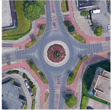
▲ Leeuwarden (Pays-Bas), Archipelweg : la piste unidirectionnelle n'a pas la priorité et perd son revêtement rouge à chaque traversée de chaussée. La priorité visuelle dictée par l'aménagement est conforme au régime de priorité (y compris pour les piétons, qui ici n'ont pas priorité non plus). (Google Maps)
