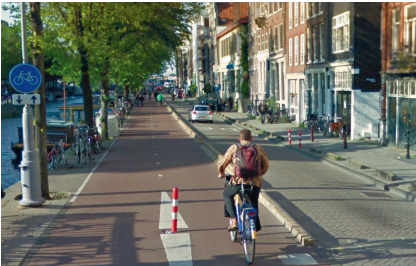
▲ Amsterdam (Pays-Bas), Geldersekade : le potelet au centre de la piste bidirectionnelle est bien signalé mais reste dangereux en cas de collision. (Google Street View)
