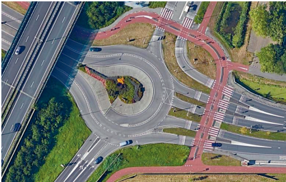
▲ Papendrecht (Pays-Bas), Burgemeester Keizerweg : une alternative un peu extrême au passage dénivelé : la piste bidirectionnelle ne croise que deux branches, où elle a la priorité, avec un îlot refuge et un plateau traversant pour chaque file de circulation entrante et sortante. (Google Maps)
