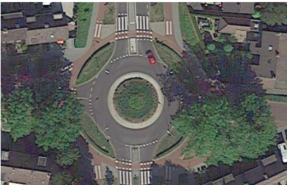
▲ Veldhoven (Pays-Bas), De Dom : un giratoire proche du minimum possible avec 20 m de rayon (13 pour la chaussée et l'îlot central). (Google Maps)
